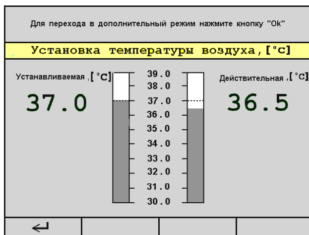
Рисунок 2.4.2 – Изображение экрана при переходе границы диапазона
