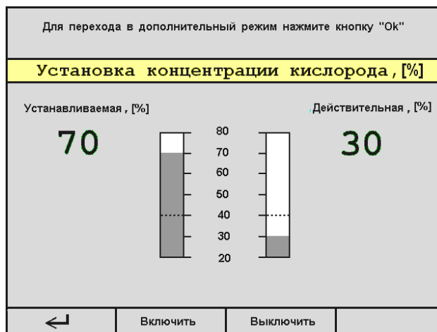
Рисунок 2.4.14 – Изображение экрана при переходе через границу диапазона
