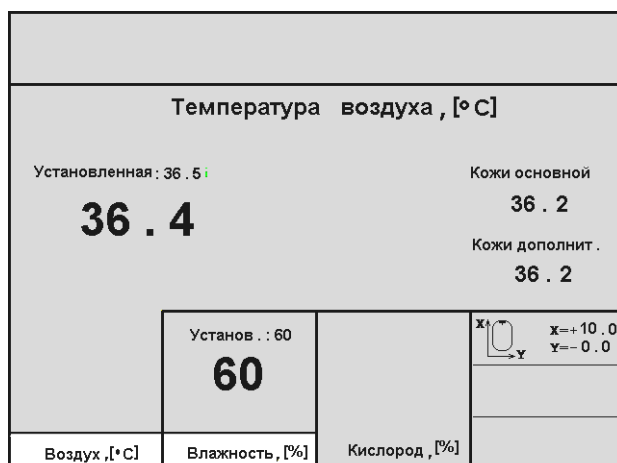
Рисунок 2.4.12 – Изображение экрана при регулировании температуры и влажности
