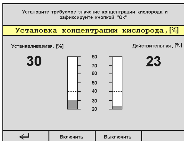
Рисунок 2.4.13 – Изображение экрана при включении регулирования концентрации кислорода
