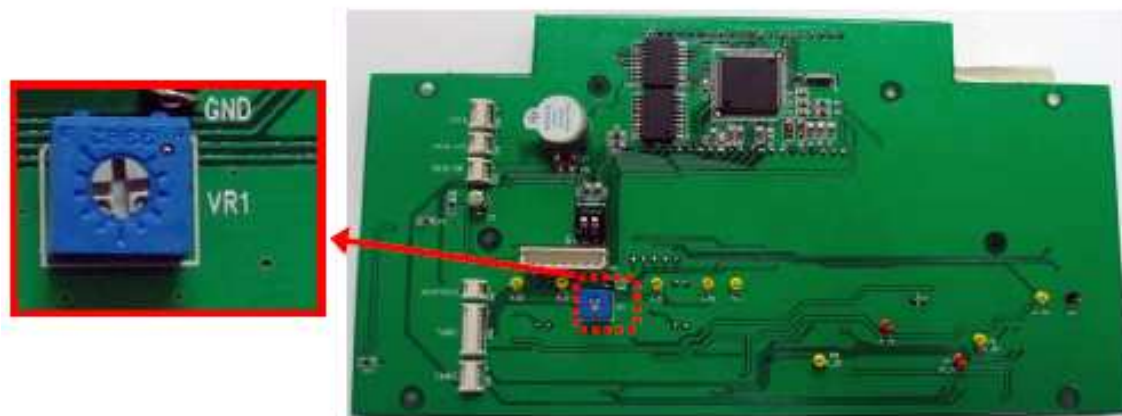
Рис. 3.1.3.4 Расположение переменного резистора для калибровки нити накаливания
