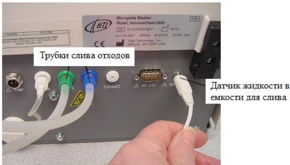
Рисунок 3-7. Трубки слива отходов и подключение датчика
