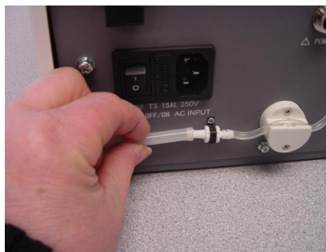
Рисунок 3-6 Подсоединение промывающей трубки
