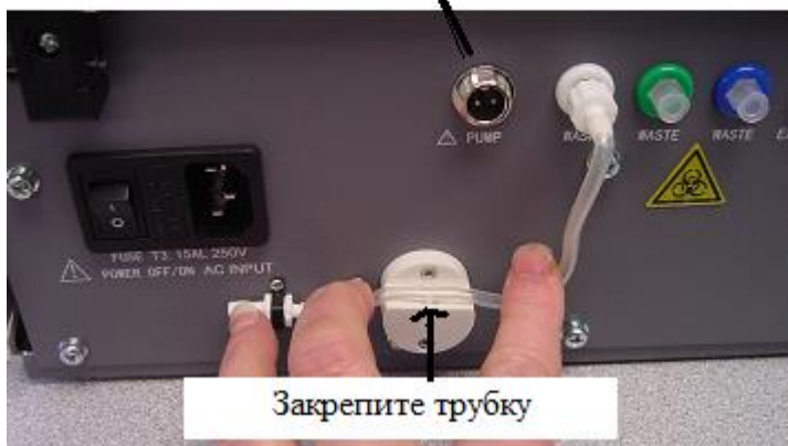
Рисунок 3-3 Закрепление трубки
