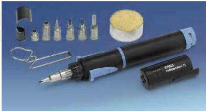
**Паяльник Independent-75 с антистатической рукояткой, жалом G072KN и пьезоподжигом; мощность 15-75 Вт, вес 73г., максимальная температура 500 град. С; работа 90 минут на заправке бутаном.**
