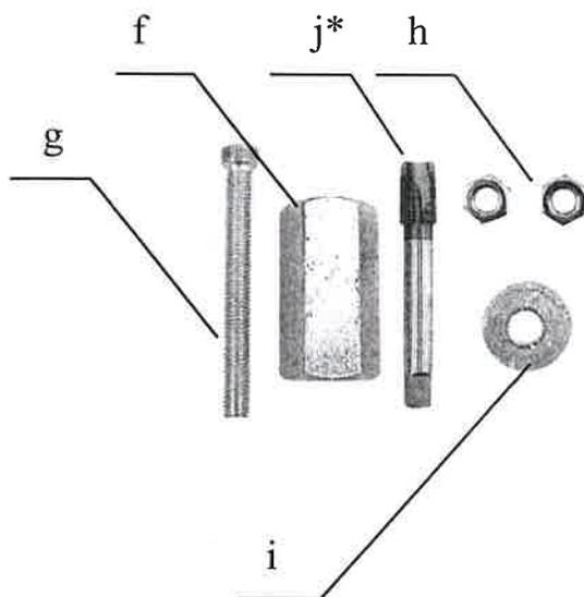
1. Lisovacia sada na nalisovanie ojničného ložiska.
