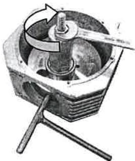
7. Na čap kľuky (kľuka je zaistená) doťahovaním prítlačnej matice ložisko pomaly nalisujeme.
