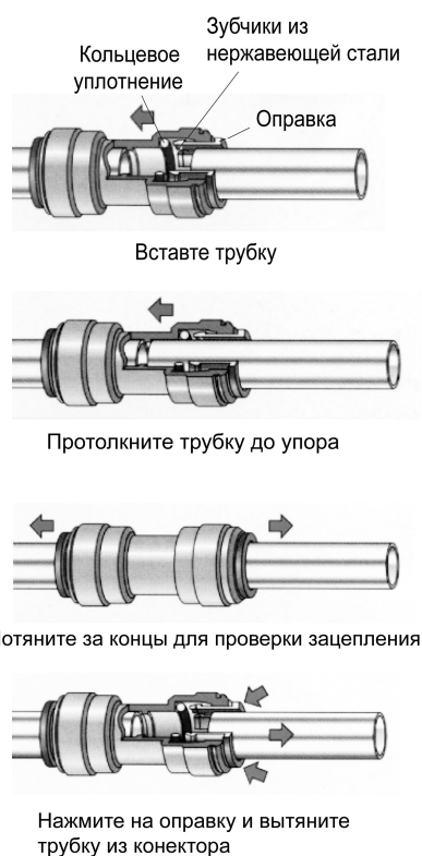
Рис. Б. Присоединение гибкой трубки к коннекторам
