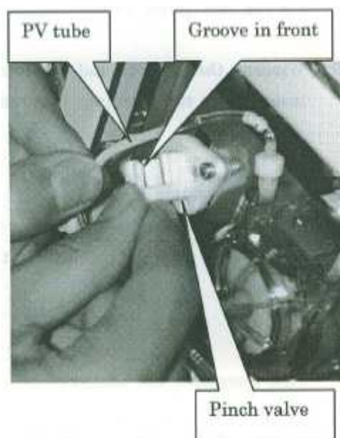
Поливиниловая трубка, Паз спереди, Нажимной клапан Смена поливиниловой трубки
