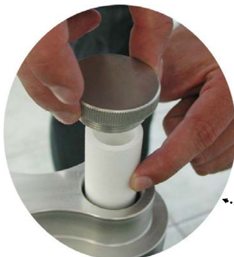
Замена фильтровального вкладыша
