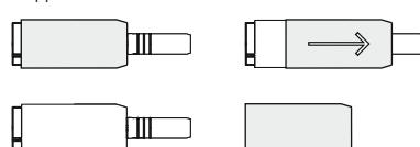
Снятие кожуха. У моторов серии MC2 (IR) и MC2 GTAV, кожух для стерилизации отсутствует. Пожалуйста, смотрите руководство по эксплуатации, в нем вы найдете более подробную информацию.
