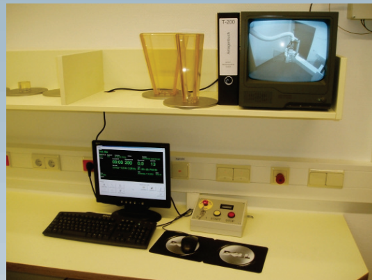
Steuerrechner (Schaltrum) / Control PC: Mittels PC werden alle Eingaben an das Gerät vorgenommen. Durch Verbindung zum Netzwerk und ISDN ist die Arbeitsstation ebenfalls Schnittstelle zur Klinik. / With the PC all inputs to the unit are to be done. By connection to the local network and ISDN the workstation is an interface to the whole hospital.
