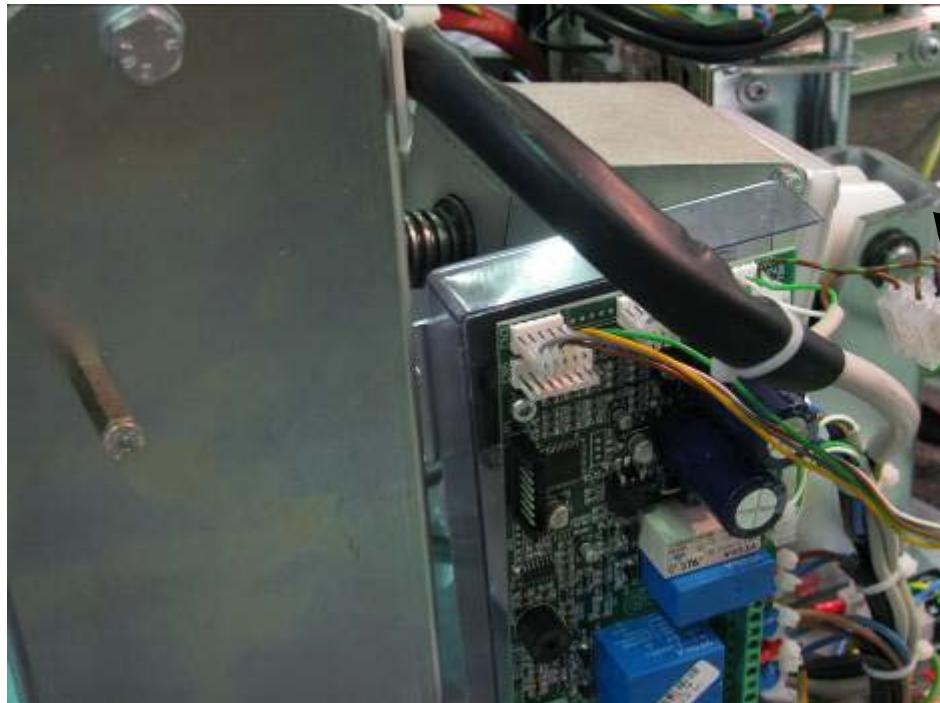
Вместо перемычки подключить контакты проводов, идущих из блока плевательницы от микровыключателя системы безопасности, расположенного на столике ассистента.
