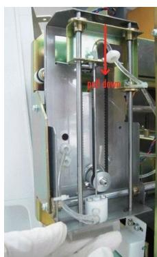
Перед настройкой позиций иглы 4 и 5 нужно установить на измерительные камеры **инструмент для горизонтального выравнивания иглы (Probe horizontal alignment tool)**. Инструмент устанавливается как показано на фото внизу:
