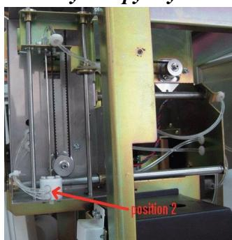
2. В новых версиях просто нажимаем клавишу "Отправить" напротив параметра **"Позиция иглы 2"**
