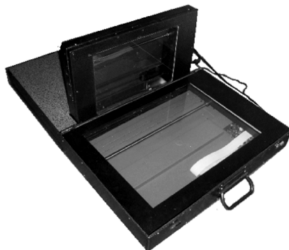
Рис. 3. Модуль «ПлантаСкан» – трехкоординатное сканирующее устройство
